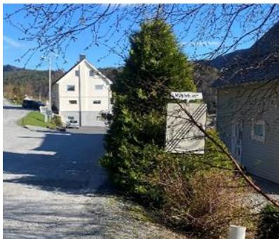
Bilde til v. er eit eksempel på at nødvendig fri sikt er hindra som følge av beplantning. Som mynde må kommunen gjennom forvaltningsvedtak gi pålegg til grunneigarar om nødvendig rydding langs veg for å ta i vare behovet for fri sikt både til vegbane, vegkryss, vegskilt, mm.
